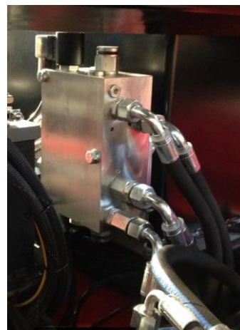
28. Booster zur Verwaltung der dritten Geschwindigkeit der Fahrbewegung
